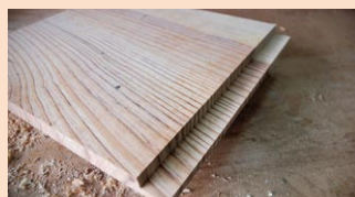
L'usinage de cette feuillure d'assemblage est vraiment impeccable... le montage n'en sera que plus facile.
